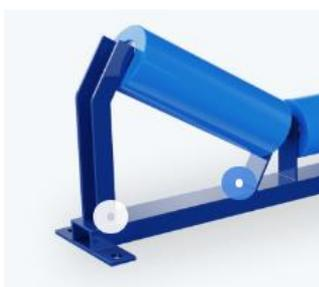
Для установки роликов используются кронштейны с различными типами пазов.
