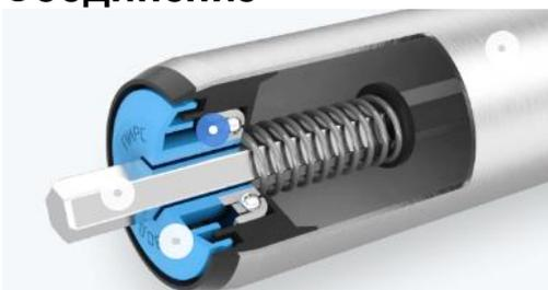
Корпуса подшипников устанавливаются на ось и запрессовываются в обечайку. После запрессовки происходит дополнительное обжатие кромки. Это существенно увеличивает прочность конструкции. Такое решение позволяет использовать ролик без боязни повредить груз или ленту выступающими краями.
